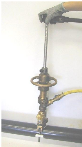
1-Déverrouiller et dégager l'arbre
