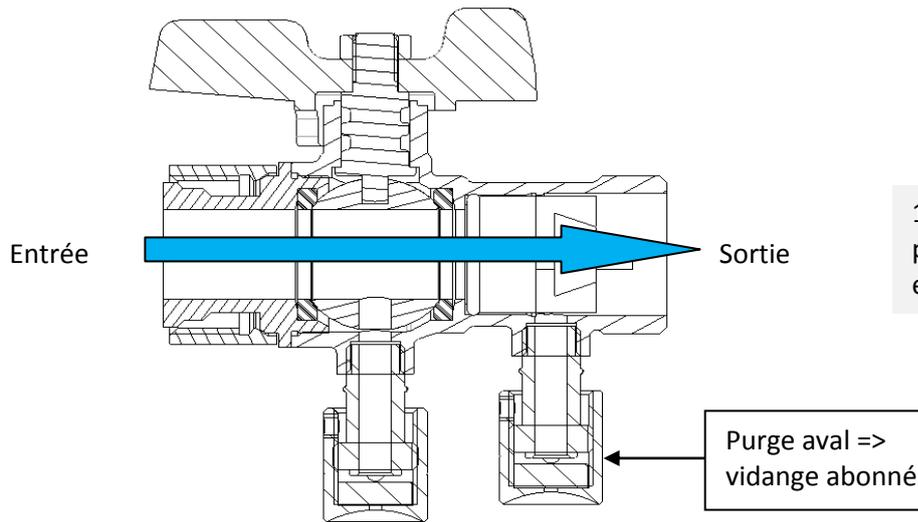
1-Vérifier la mise sous pression du réseau abonné en ouvrant la purge aval
