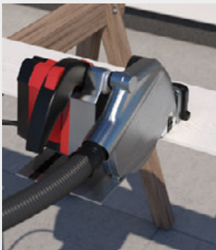
La face peinte des lames doit être orientée vers le bas avec la plupart des scies circulaires équipées d'une lame Hardie™ Blade. Nous conseillons de vérifier à deux reprises avant de commencer à couper.
