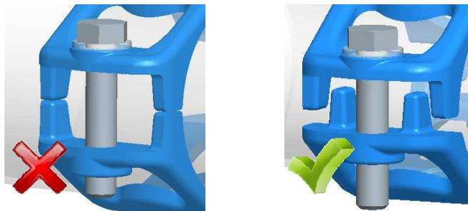
Fixer les demi-colliers en répartissant le serrage alternativement sur les vis HM16 (**utiliser une clé de 24**) jusqu'à atteindre la plage du couple maximum préconisé :
