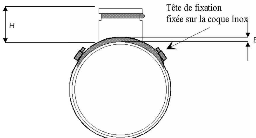
Insérer une des extrémités de chacune des 2 bandes de tension - partie mâle- dans la tête de fixation correspondante, serrer jusqu'à ce que l'extrémité de la bande de tension sorte de la tête de fixation (15 à 20 mm).
