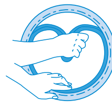
Montage du joint
