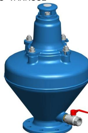
Ventouse trifonction pour réseaux d'assainissement assurant l'évacuation et l'admission d'air à grand débit pendant les phases de remplissage et de vidange de la conduite et le dégazage sous pression.
