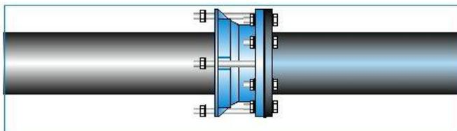
5) Serrer progressivement en croix les écrous de la contrebride jusqu'à obtenir le couple de serrage (35Nm à 40 Nm).
