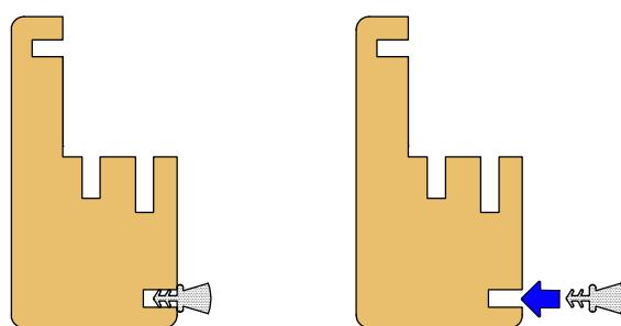
Insérez les joints brosse dans les rainures des deux traverses.
