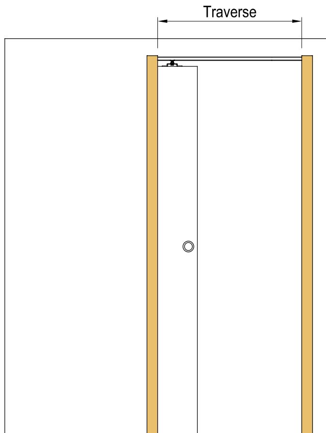
Mesurez la distance entre les couvre-joints afin de déterminer la largeur des traverses.
