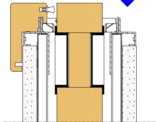
Vérifier l'alignement, si nécessaire, ajustez-le avec le positionnement du montant de réception.
