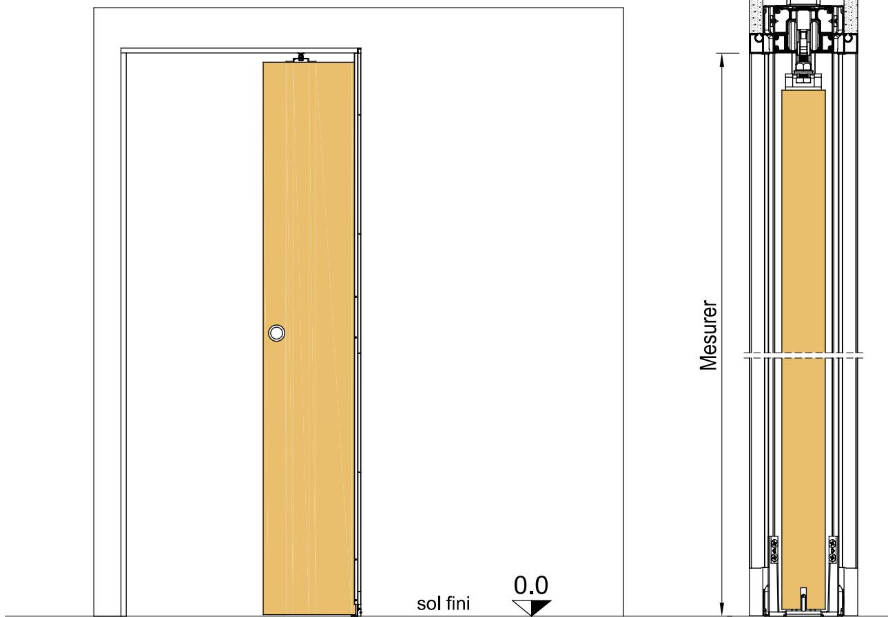
Ajustez la longueur des montants en les recoupant à la hauteur souhaitée.
