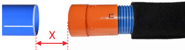
FIGURE N°21 : MESURE DE LA LONGUEUR NÉCESSAIRE POUR LE RACCORDEMENT ENTRE LE DRAIN BATIFIBRE® ET UN TUBE PVC Ø100
