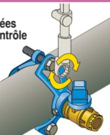
**IMPORTANT** : seul, le respect du couple de serrage optimise la compression du joint pour garantir une étanchéité totale et durable et préserve la canalisation.
