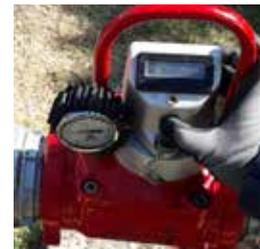
**5** - Refermez la vanne du compteur lentement et par paliers jusqu'à l'étanchéité, fermez le poteau et vérifiez que la pression reste stable :
