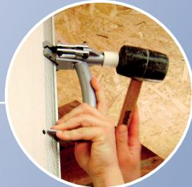
le Microfix, pour une fixation à sec, simple et pratique (pas de clous, vis ou agrafes).
