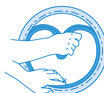
Montage du joint sans lubrification au préalable
