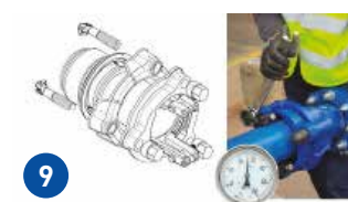
9 METTRE EN PRESSION (VOIR LES PERFORMANCES DE TENUE EN PRESSION : PAGE 18)
