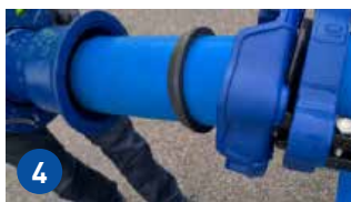
4 METTRE LE BOUT-UNI EN BUTÉE DANS LE RACCORD
