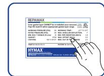
Si la couche interne du joint doit être enlevée, pliez la couche interne, brisez la ligne de séparation en introduisant un tournevis entre les deux couches et retirez la couche.
