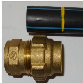
5-Vérifier que l'écrou soit serré juste en contact du joint, puis desserrer d'1/4 tour
