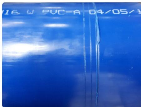
Le joint du FITT Bluforce RJ est spécialement conçu de manière à résister aux contraintes dues aux pics de pression internes et à la traction due aux mouvements du sol ou aux équipements mécaniques.
