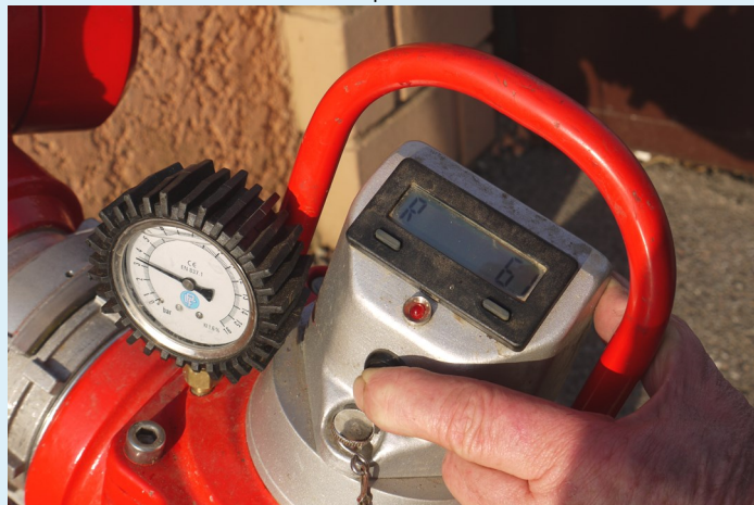
3 - Contrôle de la pression à 60 m 3 /h
