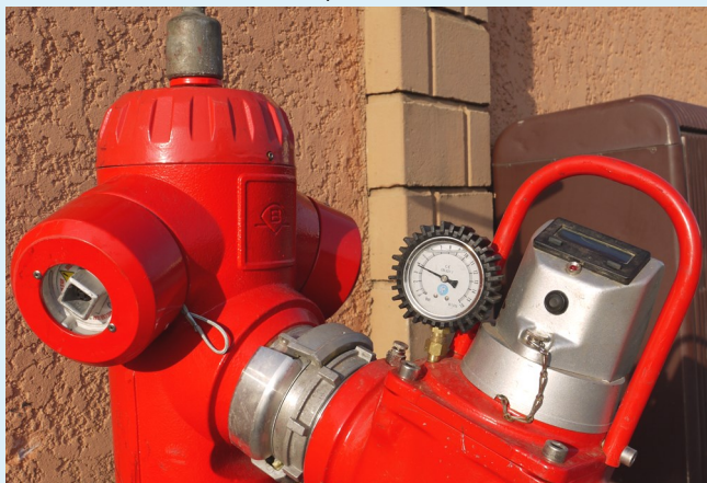
1 - Contrôle pression du réseau
