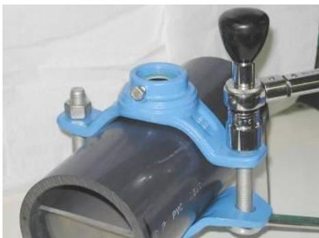
4-Visser le robinet jusqu'au contact du joint puis le serrer de **2 tours minimum**
