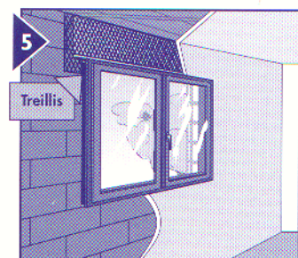
5 Avant finition intérieure, prévoir un treillis sur COFFRALUX dans le cas où le plâtre traditionnel est projeté directement sur le caisson. Faire déborder le treillis de 15 cm de chaque côté du COFFRALUX.
