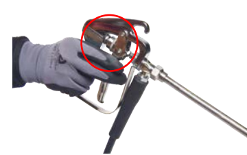
Tourner la vis de réglage et appuyer sur la gâchette pour obtenir un motif de pulvérisation uniforme. A l'aide de la vis de réglage du pistolet professionnel, la largeur de pulvérisation peut être ajustée.
