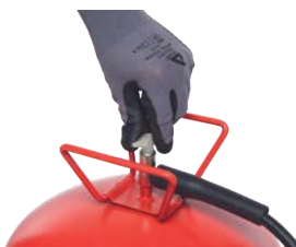
Tourner dans le sens anti-horaire, la valve blanche de la bonbonne, jusqu'à ouverture. Ne pas fermer la valve tant que la bonbonne n'est pas vide (afin d'éviter que la colle présente dans le flexible et le pistolet ne sèche).
