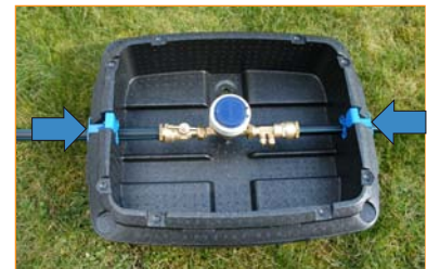
3. Clipsage des cales de maintien (bleu pour 25 ext. et noir pour 32 ext.) Maintien de la robinetterie et des PE sans outils
