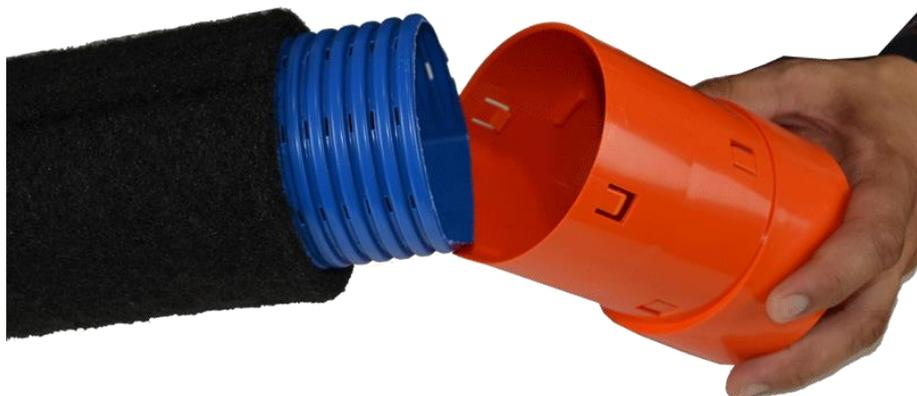
Afin de mettre en place le manchon **BATIFIBRE<sup>SN4</sup>** sur le drain, positionnez la partie plate du manchon dans l'alignement de la cunette du drain, comme présenter sur la figure 17.
