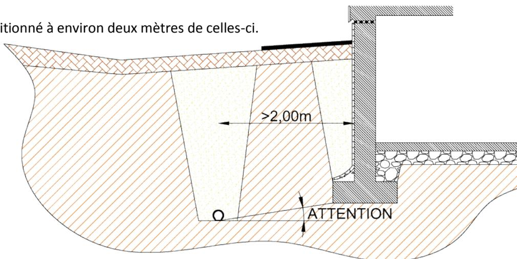
FIGURE N°10 : POSITIONNEMENT A DISTANCE DES FONDATIONS
