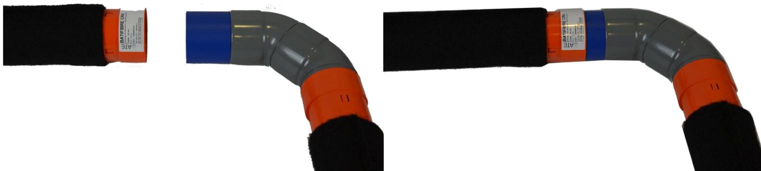
**FIGURE N°23 : RACCORDEMENT DU DRAIN **BATIFIBRE<sup>SN4</sup>** LORS D'UN CHANGEMENT DE DIRECTION A 90° A L'AIDE DE DEUX ACCESSOIRES PVC Ø100 A 45° MF**
