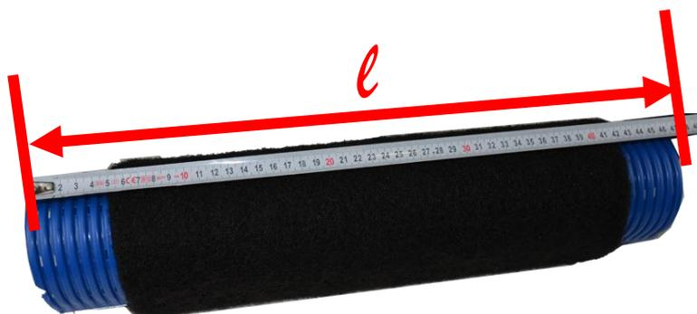
FIGURE N°20 : Mesure de la longueur nécessaire d'un drain BATIFIBRE<sup>SN4</sup> sans manchon pour le raccordement entre deux drains BATIFIBRE<sup>SN4</sup> munis d'un manchon
