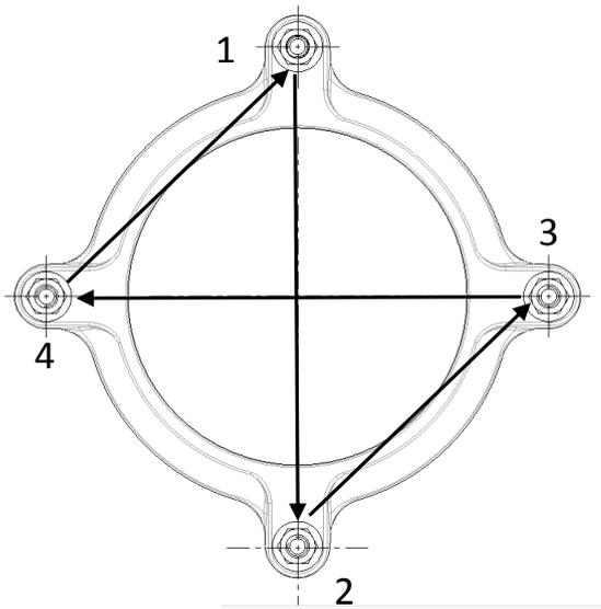
A l'aide d'une clé dynamométrique, commencer par les boulons diamétralement opposés en vissant les écrous d'un ou deux tours à la fois afin d'obtenir un serrage uniforme.
