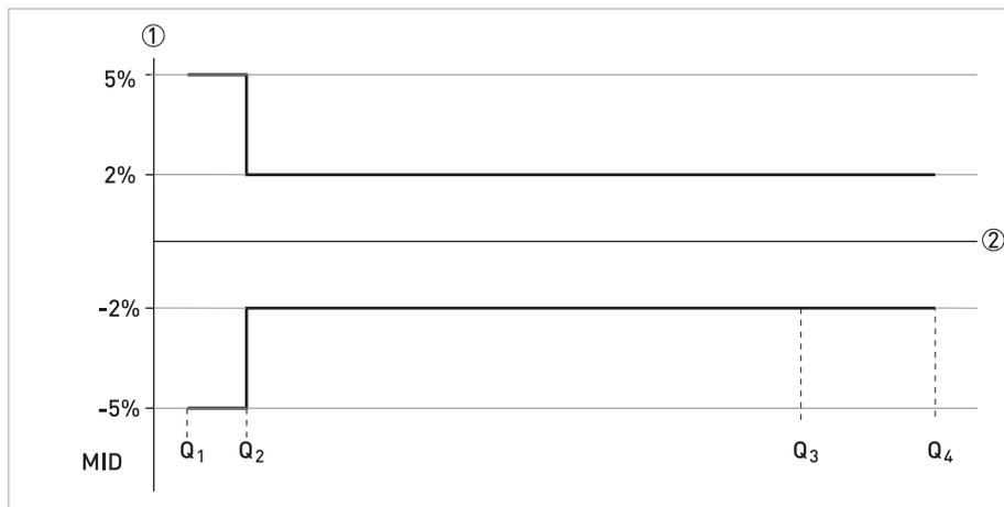
Figure 8-3: Débits ISO ajoutés au schéma pour comparaison avec MID
