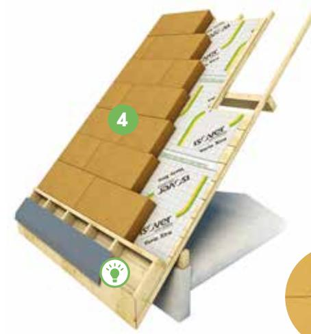
**4** Mise en place de la 1<sup>re</sup> couche d'isolation : **Multisol 110** ou **Multisol 140**. Pose bord à bord, à l'horizontal, joints décalés. Le multisol 140 dispose de rainures et de languettes garantissant un jointement optimal. Il conviendra de positionner le profil languette en partie haute de la toiture.
