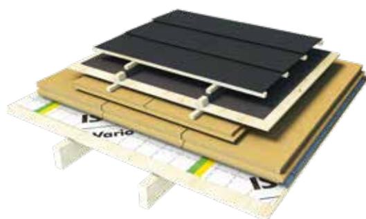
**En cas de climat de montagne**, un second platelage sera fixé sur les contre-lattes. Ce platelage supportera une étanchéité complémentaire. Dans ce cas, utiliser une membrane pare-vapeur dont le Sd est supérieur ou égal à 57 mètres ou sous avis technique. Le système est donc compatible avec la membrane Vario® Xtra et la membrane Stopvap 90.
