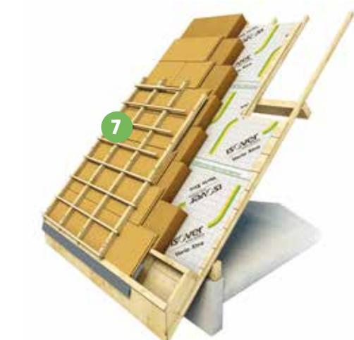
**7** Fixation des liteaux perpendiculairement aux contre-lattes à l'aide de clous (DTU série 40). L'écartement est défini par le fabricant du matériau de couverture choisi.
