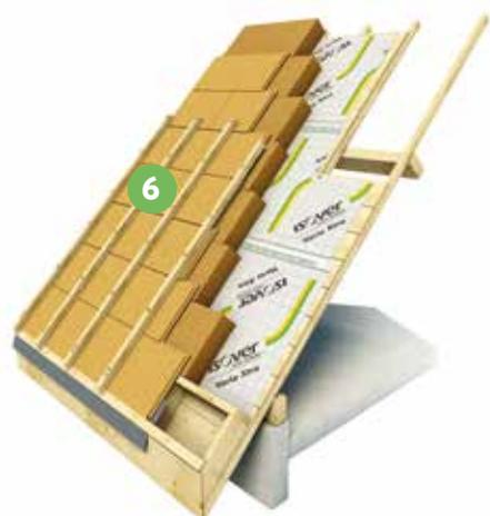
**6** Fixation des contre-chevrons de largeur 60 mm et d'épaisseur 40 mm minimum en climat de plaine, 60 mm en climat de montagne. Les positionner à l'aplomb des chevrons existants puis les fixer à l'aide de vis spéciales Sarking à double filetage (type Twin UD de la marque SFS ou Starking de chez Etanco) ou filetage continu. Pour plus d'informations, se rapprocher des fabricants de fixations.
