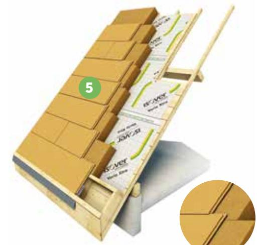
**5** Pose de la seconde couche **Duoprotect** en joints décalés par rapport à la première couche pour éviter les ponts thermiques. Le panneau doit être disposé en orientant la languette vers le haut.
