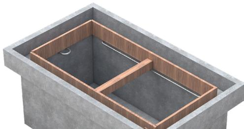
Pour la mise en place du cadre avant scellement, il est conseillé de s'aider de deux traverses fixées à celui-ci, par exemple par du fil de fer. Cette méthode dite du « brancardier » permettra, lors du remplissage, d'avoir une surface homogène sous l'appui du cadre et aucun point dur qui pourrait dégrader prématurément le scellement.
