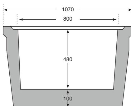
Nota : Joint torique et vis (M12) pour l'emboîtement fournis. Joints pour branchement tuyaux vendus à part. Manutention par 3 ancres 1,3 T.
