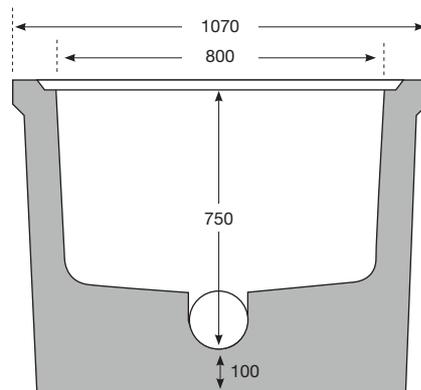
Nota : Joint torique et vis (M12) pour l'emboîtement fournis. Joints pour branchement tuyaux vendus à part. Manutention par 3 ancrs 1,3 T.
