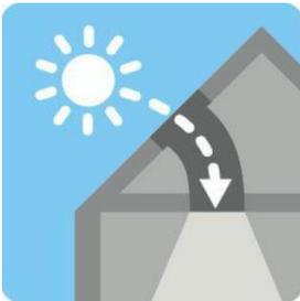
Le tube flexible est adapté pour une distance toit-plafond comprise entre 40cm et 1,50m.
