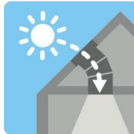
Le tube rigide est adapté pour une distance toit-plafond comprise entre 90cm et 1,7m avec possibilité d'extension jusqu'à 6m.
