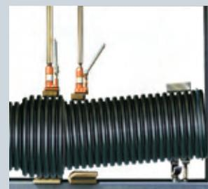
Essai de déformation
