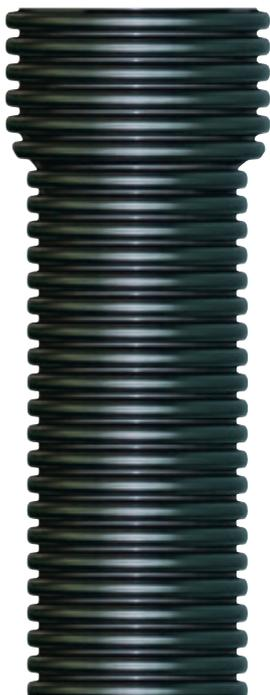
StabilTWIN ECO SN8 est le nouveau tube annelé en PP (polypropylène à haut module), double paroi, dimensionné sur le diamètre intérieur, pour conduites d'évacuation enterrées sans pression conforme à la norme NF EN 13476-3 et règlement particulier de la marque NF 442. Le caractère innovant consisté en son système de jonction conçu directement sur la barre tout en maintenant le profil du tube conservant ainsi les mêmes caractéristiques mécaniques de résistance.
