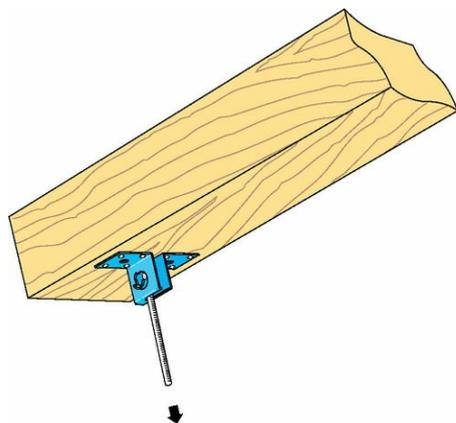
Accessoire de suspension articulé pour plafonds en plaques de plâtre Placostil® F 530 sous plancher bois ou béton
