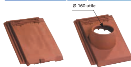
Tuile de ventilation Alpha 10 (section avec grille = 19 cm 2 ) Réf. 200.20 Tuile à douille Alpha 10 Ø 160 utile (conforme VMC) Réf. 200.32
