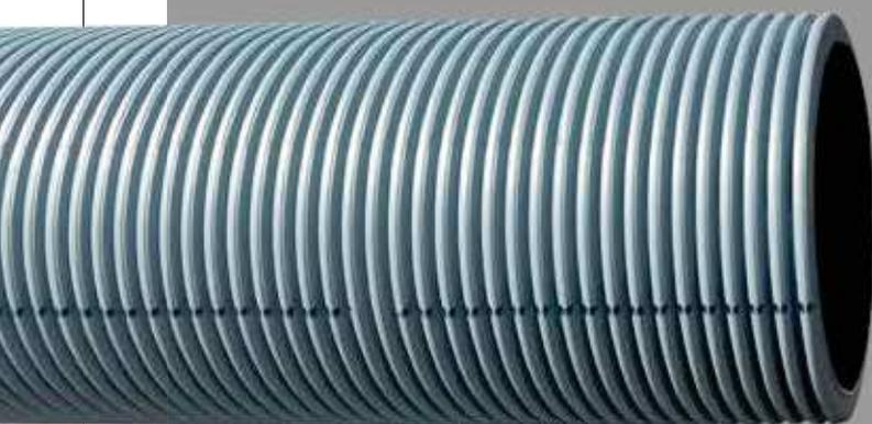
Tube pour drainage en PEHD (Polyéthylène Haute Densité) annelé à double paroi (grise externe et noire interne) «DRAIN ROUTIER», de rigidité annulaire supérieure ou égale à 5 kN/m<sup>2</sup> selon la NF EN 9969.
