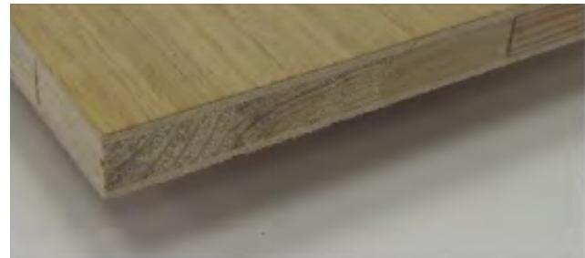
**Tablero compuesto por núcleo de listones de madera de pino o chopo recubierto con dos caras de HDF decoradas con chapas nobles para fabricación del mueble y usos decorativos. Gran ligereza y excelente mecanizado. Para uso interior no estructural en ambiente seco, clase de servicio 1 según EN 636-1.**
