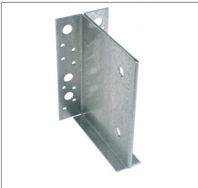
L'étrier à âme intérieure permet un assemblage discret. Le talon inférieur positionne l'étrier par rapport au bois, facilitant le montage des broches.
