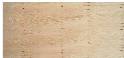
Avec défauts ouverts
