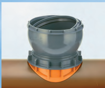
Raccord de piquage CONNEX DN/OD 160/162 sur un tuyau HSK, perçage 162 ± 1 mm
