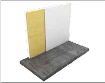
Dans le cas d'entraxe 60 cm à montants simples, la pose des panneaux s'effectue en insérant le bord du panneau dans le montant jusqu'à enfoncement complet dans le fond du montant. Puis le bord opposé est amené contre le parement en place. Veiller à limiter les ponts acoustiques en partie basse et haute, en posant les panneaux bien jointifs.
