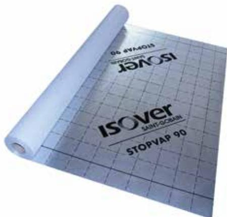
Film pare-vapeur aluminisé, armé d'un voile non tissé, dont la résistance à la diffusion de la vapeur d'eau ( $S_d$ ) est supérieure à 90 m. La membrane est quadrillée pour faciliter la découpe et la mise en œuvre.
