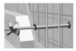
Embout conique en PVC pour utilisation avec des tubes écarteurs en PVC ou en fibrobéton. Les embouts coniques disposent d'une grande surface de contact afin de protéger le coffrage. Après avoir enlevé le coffrage, les embouts coniques peuvent être retirés avec le tire cône.
