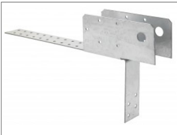
Le pied de chevron arc-bouté PCAB a été spécialement étudié pour la maison à ossature bois, le PCAB permet de répartir les poussées exercées par la charpente dans le plan vertical et horizontal. Il doit être installé à l'intersection du solivage, du mur et du chevron.
