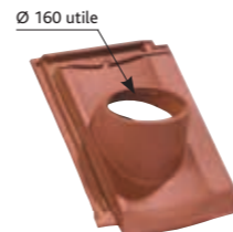
Tuile à douille Jura 10 Ø 160 utile (conforme VMC) Réf. 207.32
