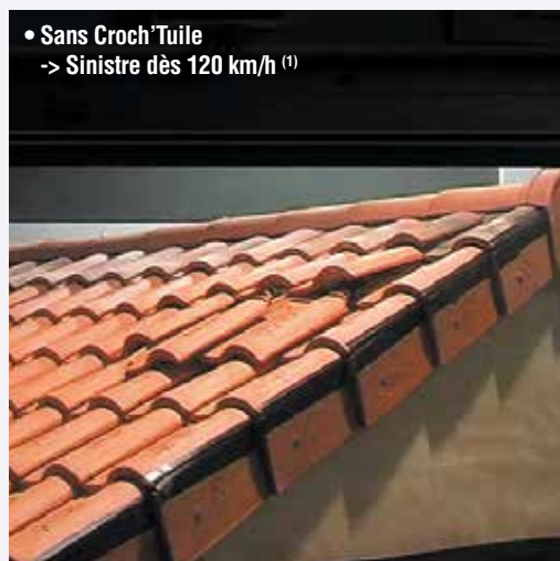
Test comparatif avec Croch'Tuile® sur la tenue à l'arrachement par rapport à d'autres types de fixation
