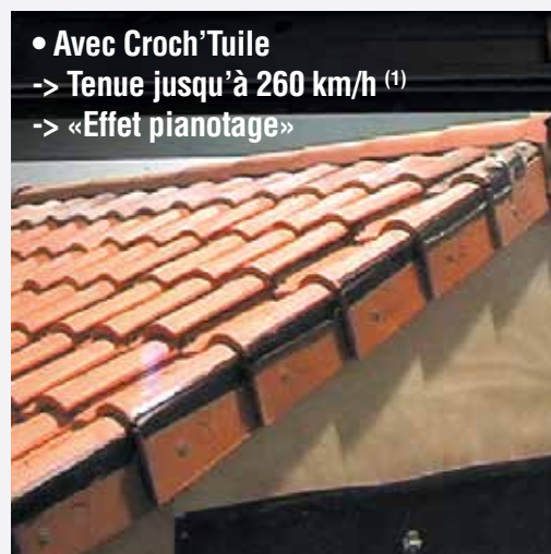
Test comparatif avec Croch'Tuile® sur la tenue à l'arrachement par rapport à d'autres types de fixation
