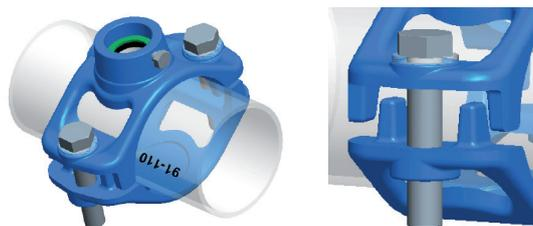
En position inversée de l'une de deux demi-bridés (180°), la fonction des taquets est libérée permettant ainsi le montage pour des canalisations fibre-ciment, acier et fonte.
