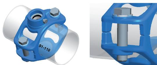
Par conception, le collier ROC GT2 est ajusté aux diamètres extérieurs des canalisations plastique, son serrage étant sécurisé en butée sur les taquets.
