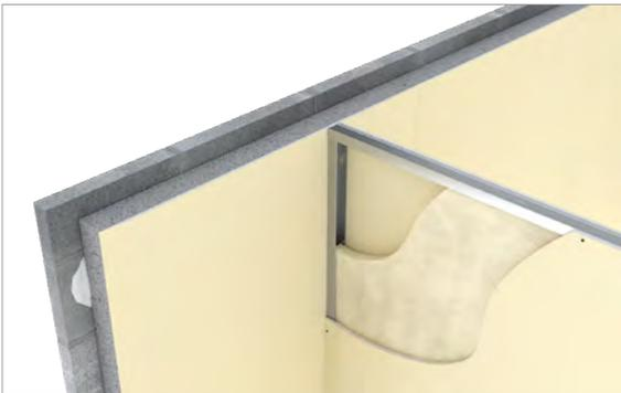
› Cloison simple parement : doublage filant mis en œuvre avant cloison.
