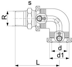
**Coudes à 90° de transition, PE/Acier (acier inoxydable 1.4305), avec filetage mâle et fixation du tube intégrée**
