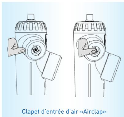
Clapet d'entrée d'air «Airclap»
