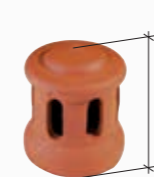
Lanterne grand modèle Ø 126 utile (Section d'aération : 80 cm 2 ) Réf. 1001 (3)
