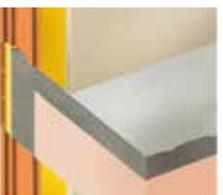
Avec planelle isolée R<sub>p</sub> = 1,00 m<sup>2</sup>.K/W
