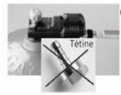
Vissez le tuyau (extrémité noire) sur l'embout fileté du détendeur ménager en vous assurant de la présence d'un joint et de son bon état. Si une tétine amovible de type Butane/ Propane est présente, dévissez la préalablement avant de visser votre tuyau.
